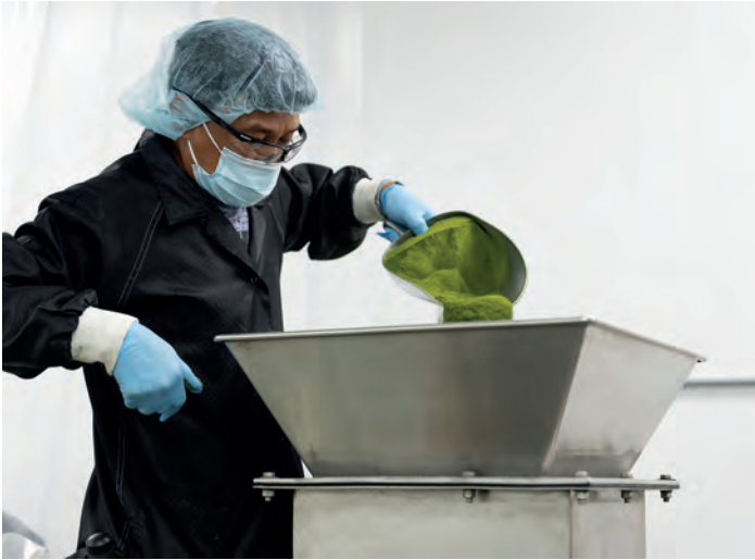
Een operator leegt een schep met handmatig afgewogen poeder in de invoer van de mixer.
