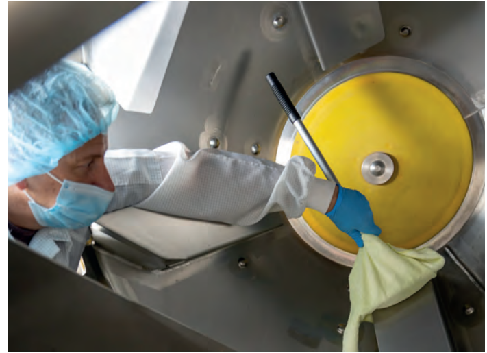
De zachte vierledige werking van de mixer laat vrijwel geen residu achter, wat het reinigen tussen batches vereenvoudigt.
