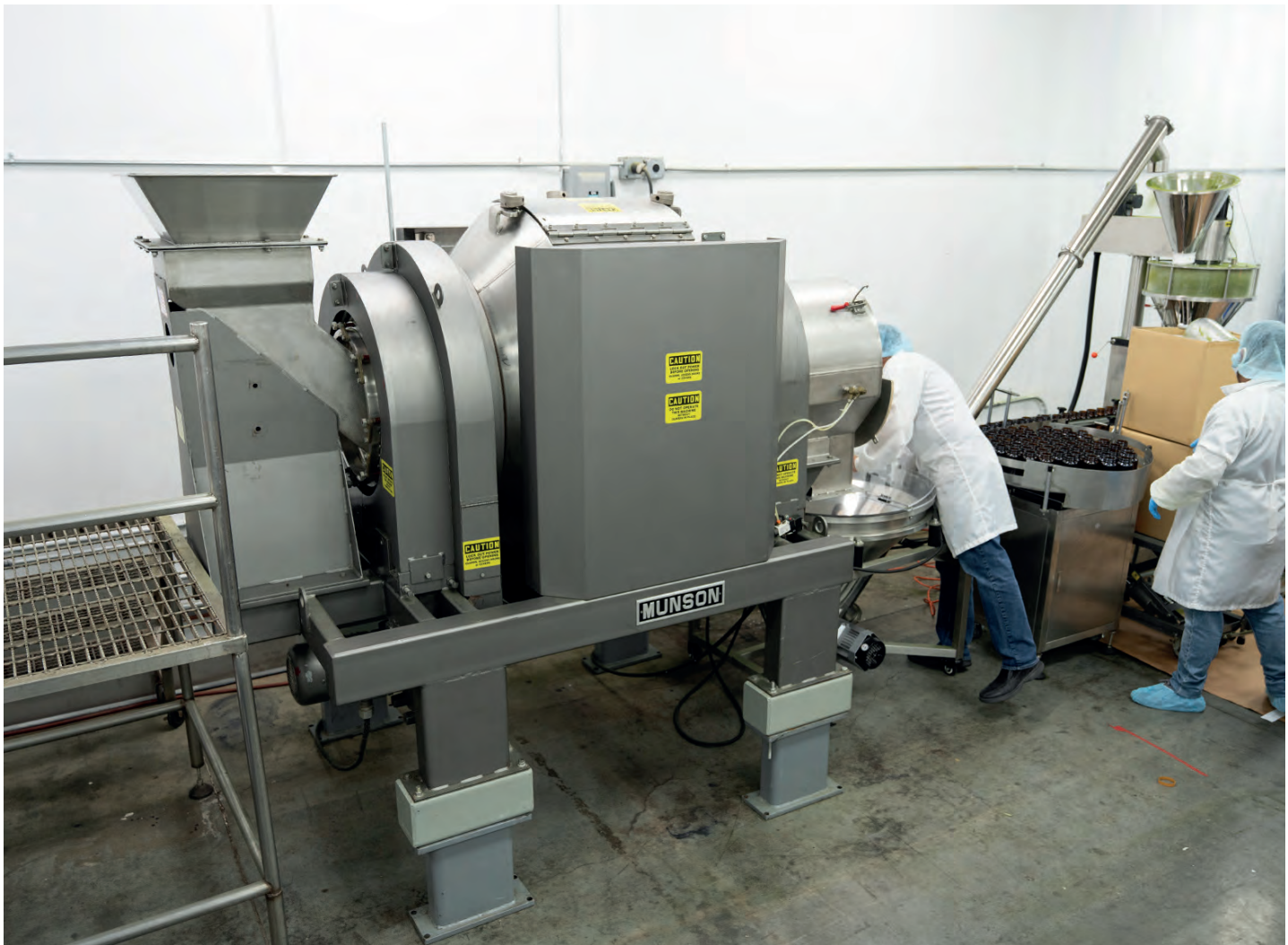
De Rotary Batch Mixer met een capaciteit van 425 liter lost in een schroeftransporteur die gemengde poederproducten naar een vulmachine transporteert.
